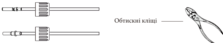
Рис. 5.4 Обтисніть контактний штифт до дроту
